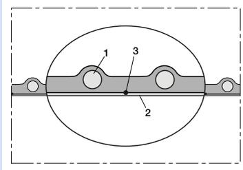
抗靜電聚氨酯軟管, 重型, 接地線
