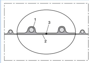
**抗靜電聚氨酯軟管, 輕型, 耐微生物燃, 接地線**
