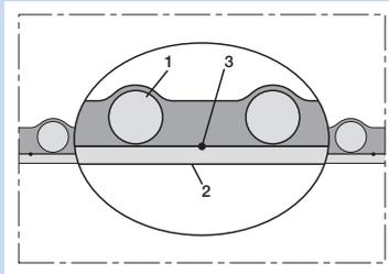
抗靜電聚氨酯軟管, 超重型, 接地線
